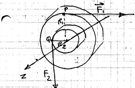
Soluzione: a) le forze  $\vec{F}_1$  e  $\vec{F}_2$  sono applicate dalla fune nei punti P e Q a distanze  $R_1$  e  $R_2$  dall'asse.
