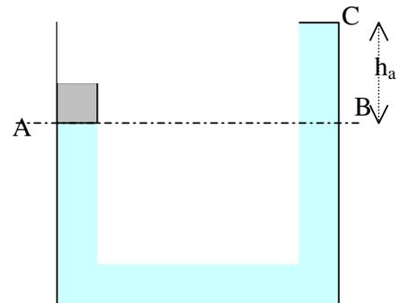
Per l'incomprimibilità dell'acqua, se l'acqua nel ramo destro si è sollevata di  $\Delta h$ , allora quella nel ramo sinistro si è abbassata di  $\Delta h$ . In totale, la differenza fra i livelli dell'acqua nei due rami è  $h_a = 2 \Delta h$  e, quindi  $\Delta h = h_a/2 = 0.0125 \text{ m} = 1.25 \text{ cm}$  (4)
