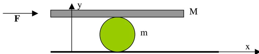
**2.1** - Supponendo nota l'accelerazione  $a_c$  del centro di massa del cilindro, si trovi l'accelerazione  $a_p$  della piastra in funzione di  $a_c$  motivando la risposta. Si trovino, quindi, le reazioni normali del pavimento sul cilindro ( $R_1$ ) e quella cilindro sulla piastra ( $R_2$ ).
