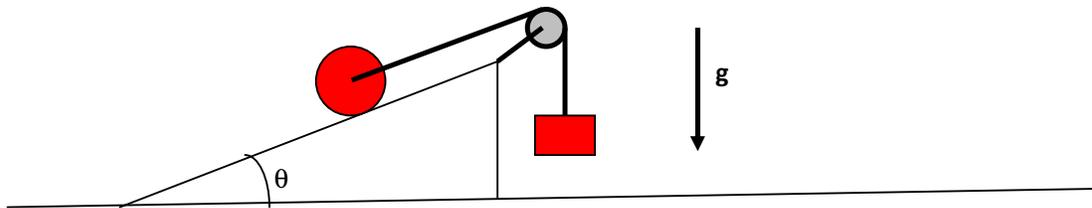
**3.1** - Nell'ipotesi che il moto del cilindro sia di rotolamento puro, si calcoli la tensione  $T$  della fune.
