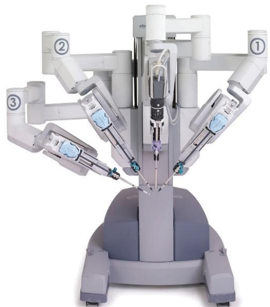
Sulla parte terminale di ciascun braccio vi è un supporto per alloggiarvi uno strumento chirurgico specifico per questo robot. Lo strumento ha uno stelo allungato, come nel caso degli strumenti laparoscopici tradizionali, ma in gran parte di questi strumenti (come nel caso di pinze o forbici) vi sono dei giunti che implementano il cosiddetto "Endo-Wrist" che
