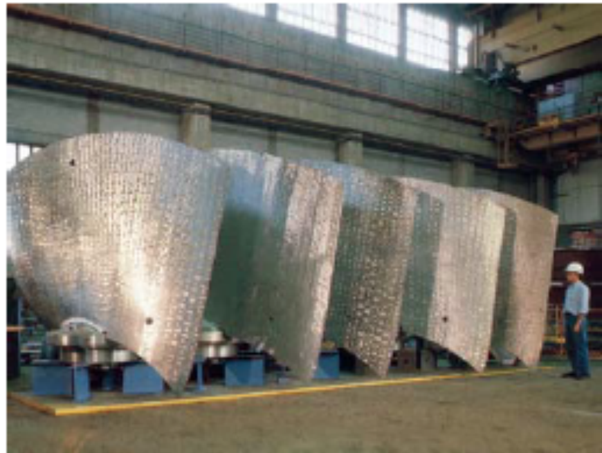
Girante Kaplan con palettature a calettamento variabile
