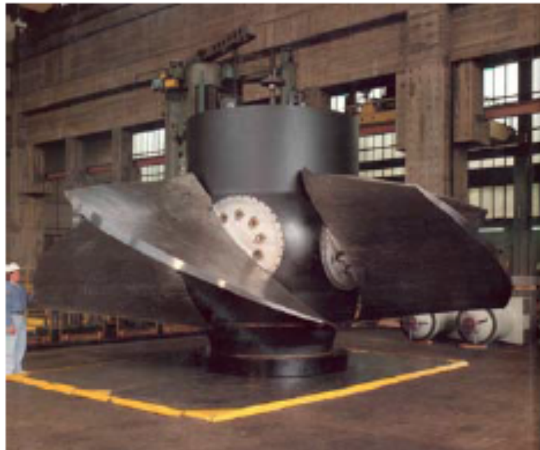
Girante Kaplan con palettature a calettamento variabile
