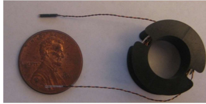
(il sensore è il cilindretto nero sopra la moneta)
