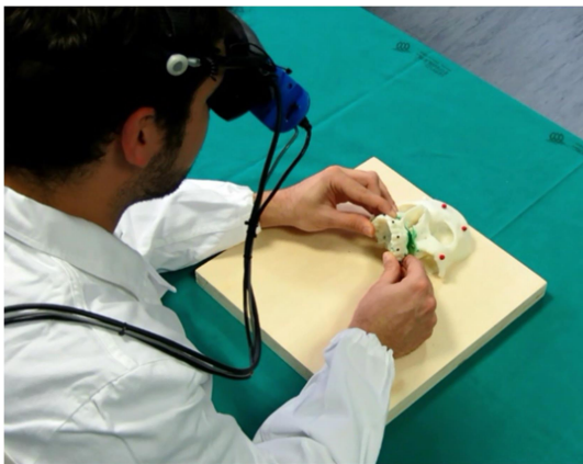
Fig. 6: Il visore per realtà aumentata mostra in verde il posizionamento dei marcatori virtuali con i quali ottenere il corretto allineamento dei marcatori reali.
