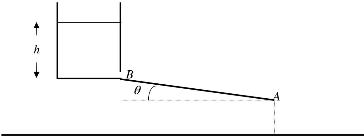
3.1 - Si trovi la velocità  $v_B$  con cui l'acqua esce da un foro rettangolare di lato  $L$  praticato sul fondo del serbatoio (punto  $B$  in figura) in corrispondenza con il canale rettangolare. (4 punti)
