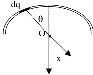
Per motivi di simmetria il campo è diretto lungo l'asse  $x$  in figura nel verso positivo e la componente  $x$  del campo è pari a:
