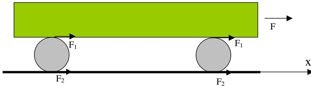
Indichiamo con  $F_1$  e  $F_2$ , rispettivamente, le componenti  $x$  delle forze esercitate sui cilindri dalla barca e dal pavimento. L'equazioni del moto di ciascun cilindro sono
